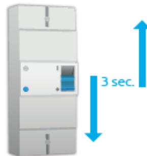
Positionnez le disjoncteur en position **O**, attendez 3 secondes et remettez le disjoncteur en position **I**.
